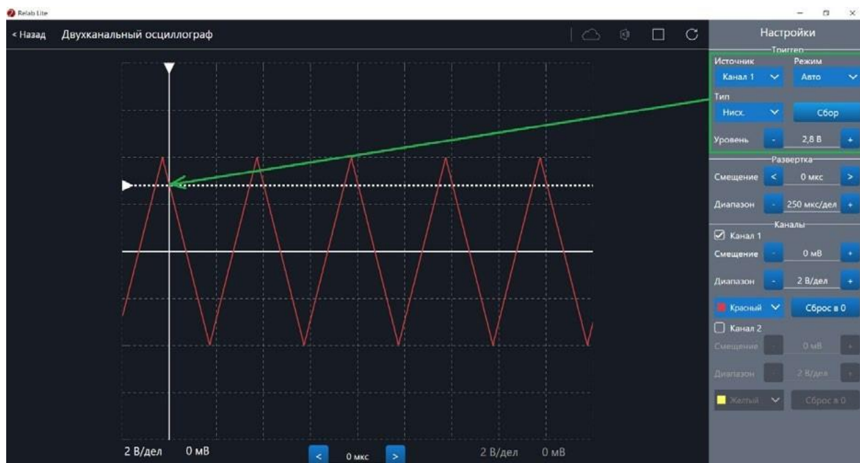
Рис. 44. Пример работы с различными настройками триггера (уровень напряжения 2,8 В)
